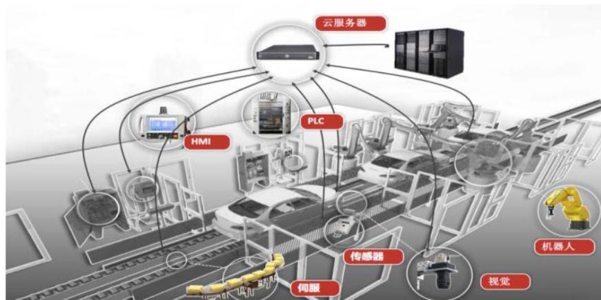
图 33：汽车行业基于工业云技术的智能制造示意图
